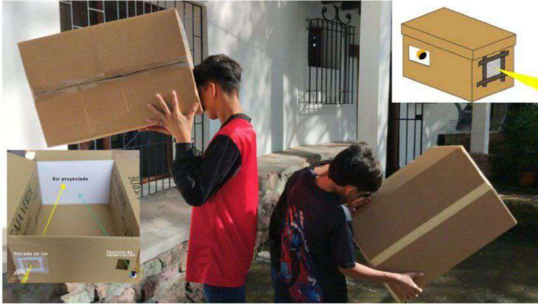
Figura 2. Ejemplo y modelo de construcción de cámara oscura
